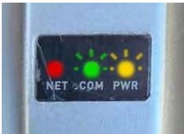
**Wichtig:** Vergewissern Sie sich, dass die grüne Leuchte schnell blinkt und dann in ein langsames Blinken übergeht. Langsames Blinken bedeutet, dass der Wechselrichter und das Update-Tool eine Verbindung hergestellt haben.
