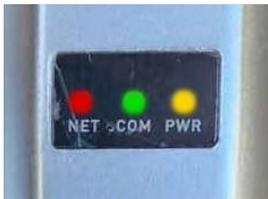
12: Sobald alle LEDs leuchten, drücken Sie kurz den Reset-Knopf auf dem Solis-Firmware-Update-Stick und die LEDs blinken anfangs sehr schnell und später langsamer.
