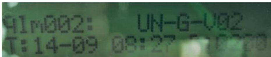
**UN-G-V** significa que las tensiones de red son inferiores al valor de protección establecido en el inversor según la norma de red local.
