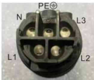
2. Messen Sie die Spannungen der Phase 1 und überprüfen Sie die Spannung gemäß dem Wechselrichter (dies muss gleichzeitig erfolgen, die beiden Displays sollten die Werte direkt nebeneinander anzeigen) Schreiben Sie die gemessene Spannung als auch die angezeigte Wechselrichterspannung auf und berechnen Sie den Fehler (Fehler =  $V$  gemessen –  $V$  Wechselrichter)
