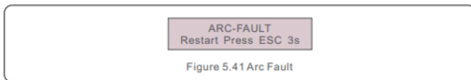
Der Installateur muss den DC-Stromkreis gründlich überprüfen, um sicherzustellen, dass alle Kabel korrekt befestigt sind.
